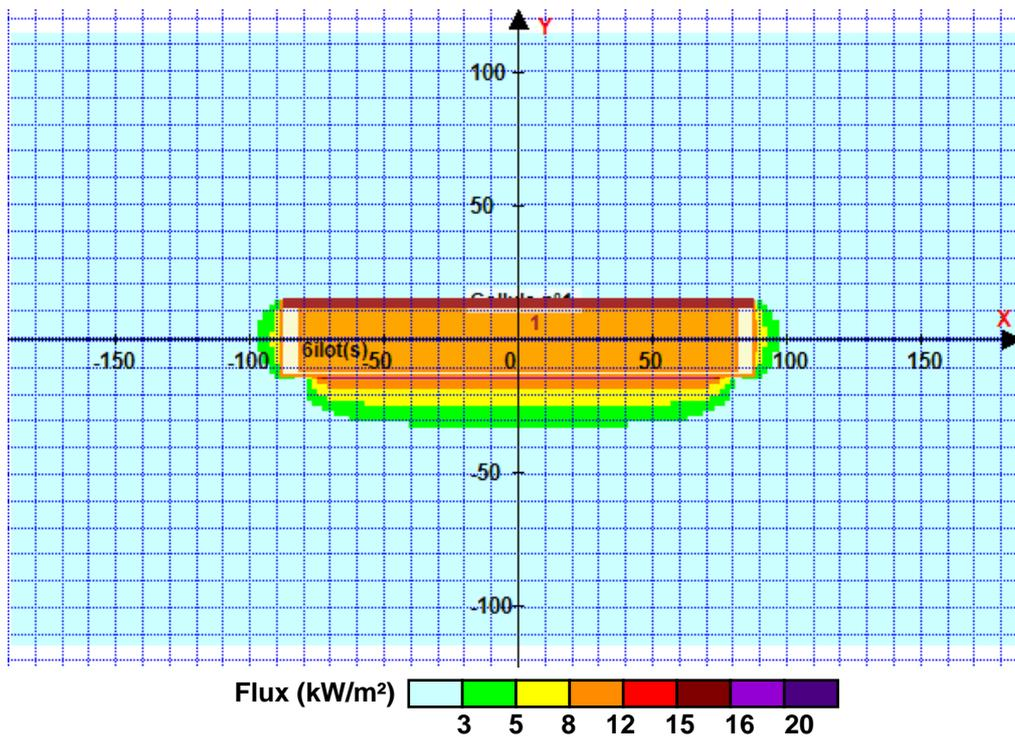
Pour information : Dans l'environnement proche de la flamme, le transfert convectif de chaleur ne peut être négligé. Il est donc préconisé pour de faibles distances d'effets comprises entre 1 et 5 m de retenir une distance d'effets de 5 m et pour celles comprises entre 6 m et 10 m de retenir 10 m.
